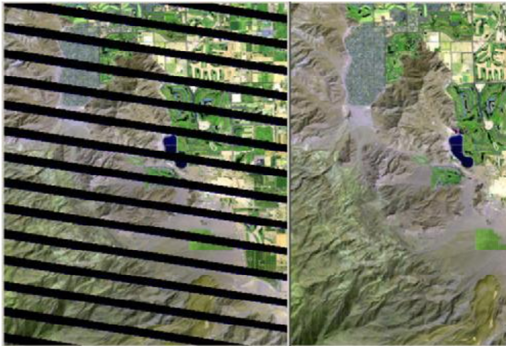
Figura 1.2: Efecto de la corrección 1G en una imagen Landsat ETM+ afectada por el SLC-Off.
